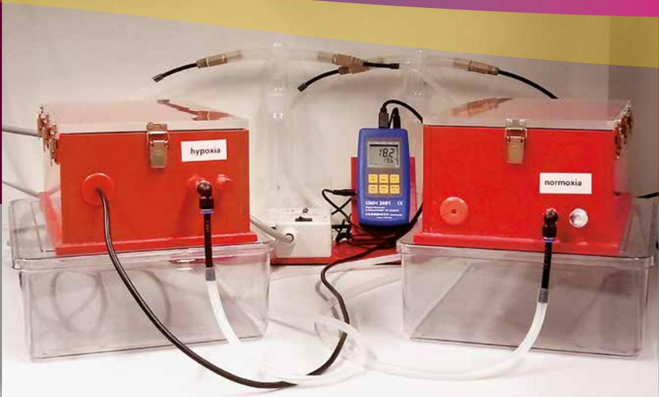
**Abbildung 2:** Einer der innerhalb des Sybacol Konsortiums untersuchten Signalwege ist der Hypoxie-Signalweg. Um hier aussagekräftige Ergebnisse zu erhalten, müssen die Würmer für einen gewissen Zeitraum einer exakt definierten Hypoxie (d.h. Sauerstoffmangel) ausgesetzt werden. Da hierfür keine geeigneten Apparaturen erhältlich sind, wurden spezielle Hypoxiekammern in enger Zusammenarbeit von Forschern und den Werkstätten der Uniklinik entworfen und gebaut (Quelle: Martin Höhne).
