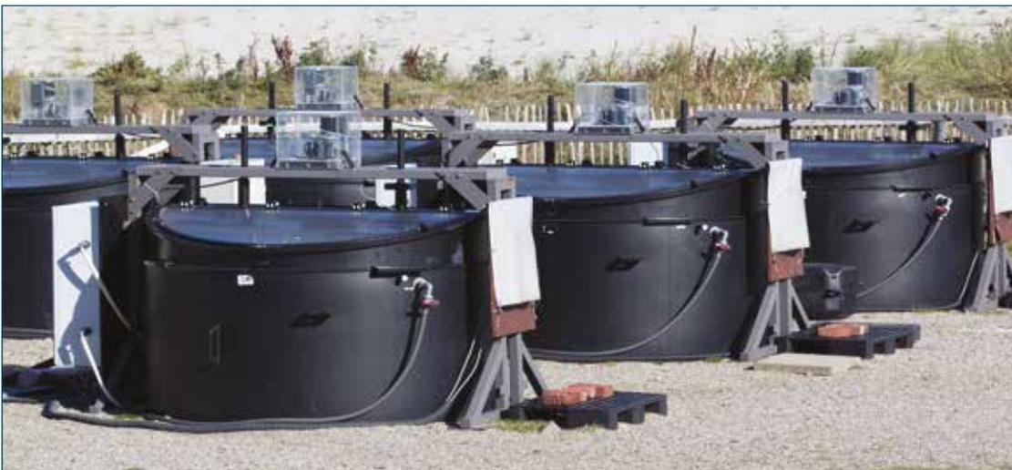
**Abbildung 3:** Sylter Mesokosmen: In 12 Tanks à 1800 l Seewasser werden experimentell die Auswirkungen von Klimaänderungen von erhöhter Temperatur und CO<sub>2</sub> mit gesteigertem Nährstoffregime auf Gemeinschaften von Wattenmeerorganismen getestet. Strömungsverhältnisse sowie Ebbe- und Flutbedingungen werden naturnah simuliert.
